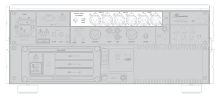
Schließen Sie an den Eingängen INPUT 1/2/3 analoge Signalquellen über ein symmetrisches NF-Kabel an.
