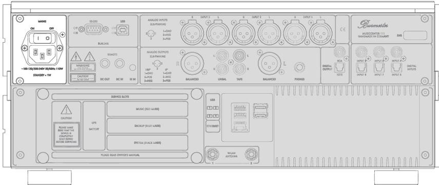
1. Stecken Sie hier das mitgelieferte Netzkabel ein und verbinden Sie es mit der Netzsteckdose.
