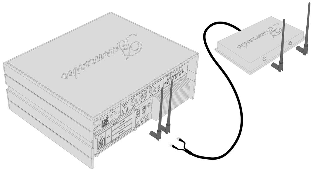
Über die WLAN-Antennen wird die Verbindung zwischen iPad® und Musiccenter hergestellt. Sie können die beiden Antennen entweder direkt in die Anschlüsse am Gerät einschrauben oder über den optionalen Antennenblock anschließen. Durch den Antennenblock und das Anschlusskabel können Sie die Antennen höher positionieren und erhalten dadurch eine größere Reichweite.
