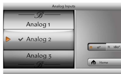
Bei Auswahl einer digitalen Quelle können Sie zudem die Sampling-Rate einstellen. Drücken Sie hierzu die Taste am rechten Bildschirmrand zur Auswahl von 96 kHz oder 192 kHz.
